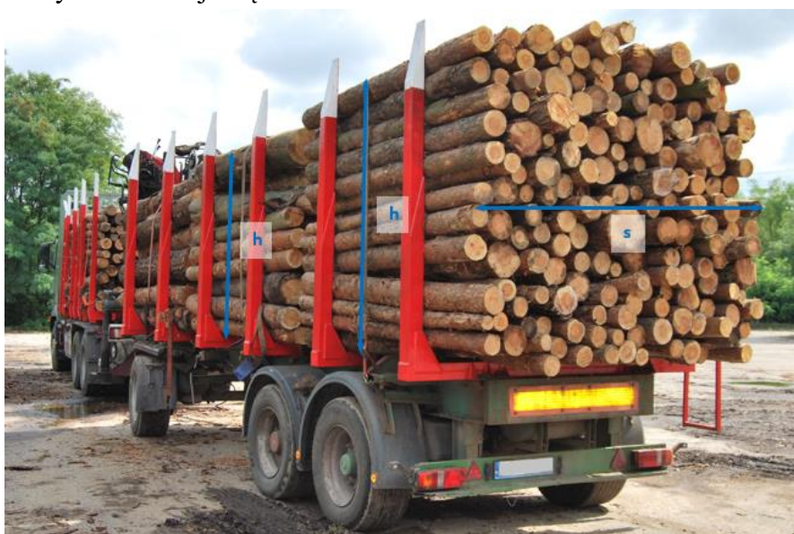
Ryc. 19. Pomiar kontrolny drewna na pojeździe wywozowym
